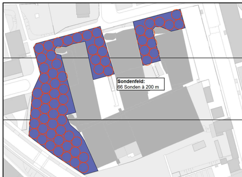
Abbildung 59: beispielhafte Darstellung Erdwärmesonden-Auslegung (Obergasser, 2022)
