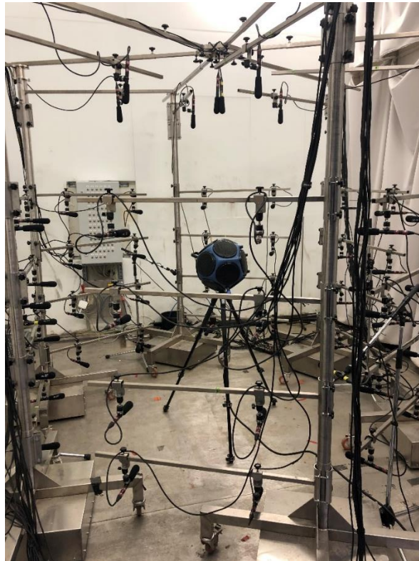
Abbildung 3: Dodekaederlautsprecher als Referenzschallquelle im Zentrum des akustischen Doms in der Außenkammer des Klimakammersystems in der AIT TechBase.
