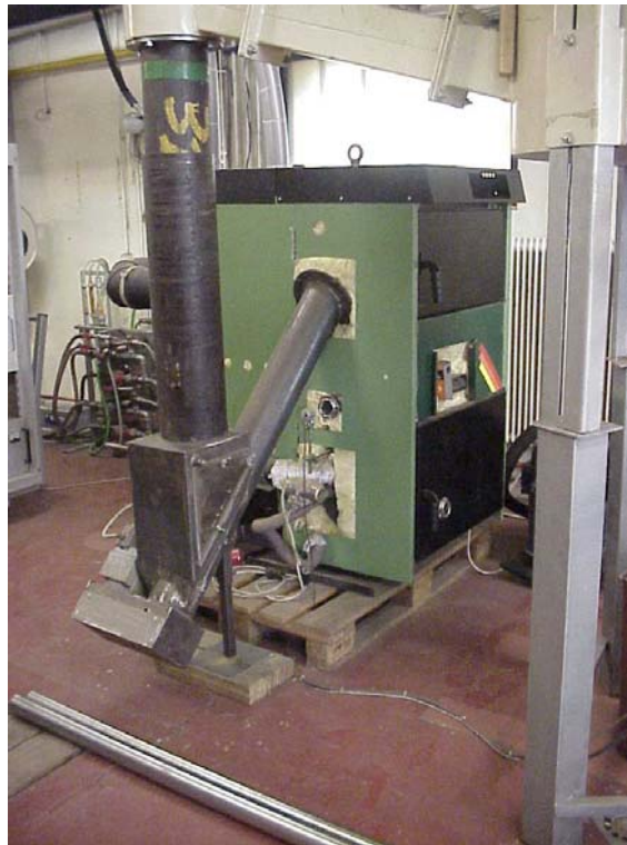
Abbildung 9: 2 Ansichten der Versuchsfeuerungsanlage: oberes Bild : Ansicht von schräg hinten ohne Wärmedämmung, unteres Bild : Ansicht von schräg vorne mit Wärmedämmung. Zu erkennen ist die schräg nach oben führende Brennstoffschnecke für die Beschickung „von oben“, unter der Brennstoffschnecke die Teile des Lichtschrankens für die optische Einrichtung für die Überwachung der Glutbetthöhe. An der Vorderseite des Kessels (unteres Bild) ist das Stellglied für die Sekundärluftzuführung zu erkennen.
