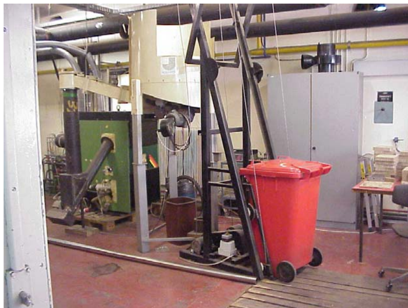
Abbildung 2: 50-kW Biomassefeuerung nach Einbindung in die übrigen Komponenten des Feuerungsversuchsstands. Man erkennt links neben der Bildmitte (erhöht) den zylindrischen Brennstoffvorratsbehälter mit dem Aufzug für dessen Beschickung. Links unten neben dem Brennstoffvorratsbehälter ist die Versuchsfeuerungsanlage mit der schrägen Brennstoffzuführungsschnecke zu erkennen.
