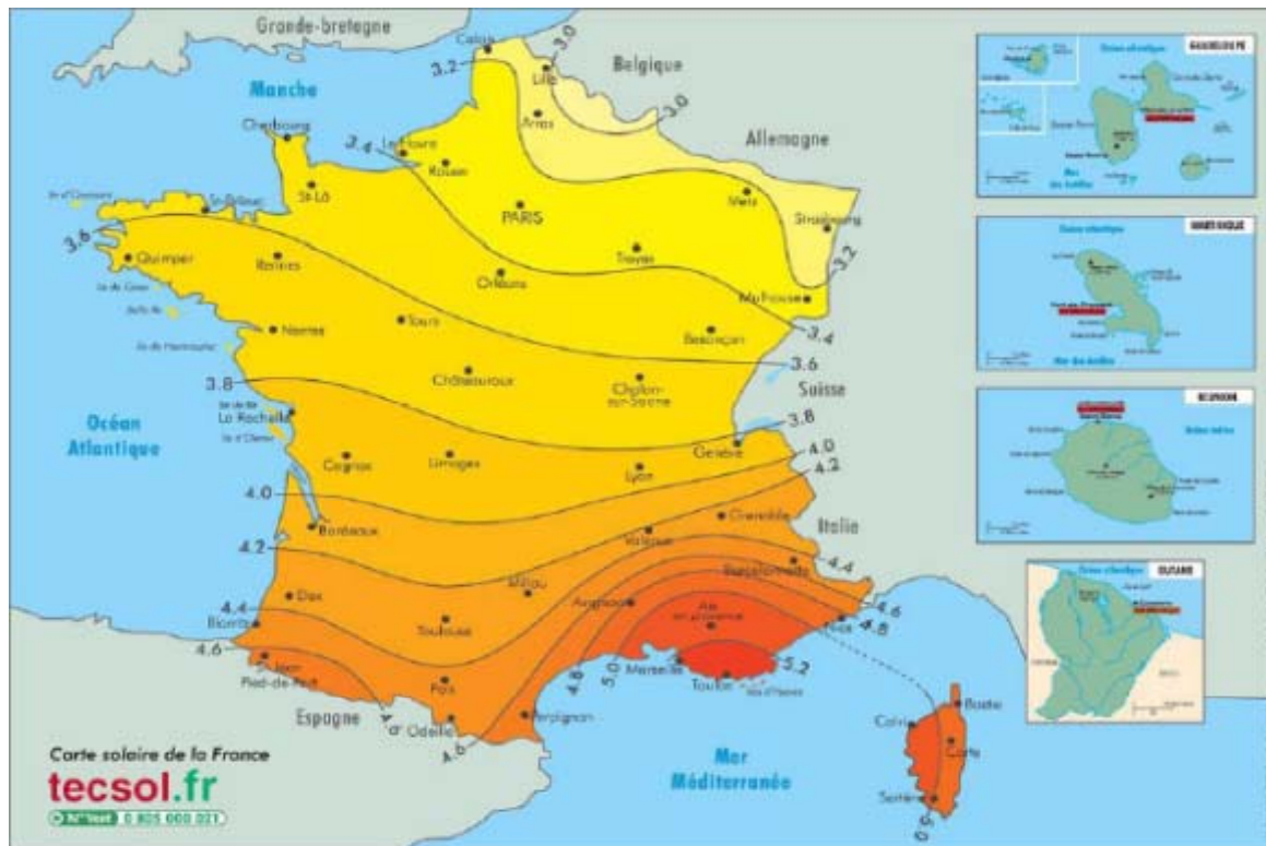
Moyennes annuelles de l'énergie reçue sur une surface orientée au sud et inclinée d'un angle égal à la latitude (en kWh/m 2 /jour) (D'après l'Atlas européen du rayonnement solaire - Commission des Communautés Européennes)
