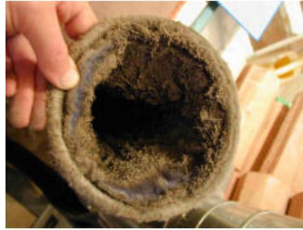
Abbildung 13: Verschmutzte Ventilfilter in Taschenfilterausführung
