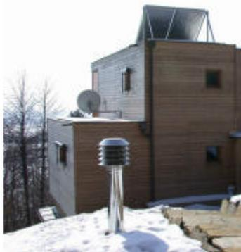
Abbildung 6: Frischluftansaugung mit freistehendem Lamellenhut mit Ringfilter G4
