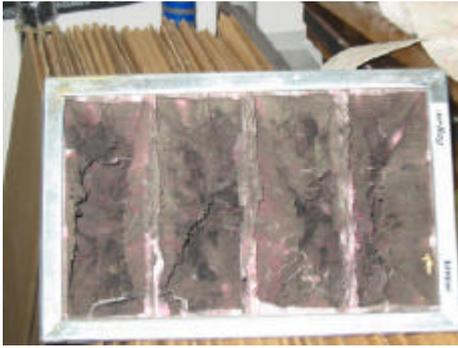
Abbildung 12: Verschmutzter Taschenfilter
