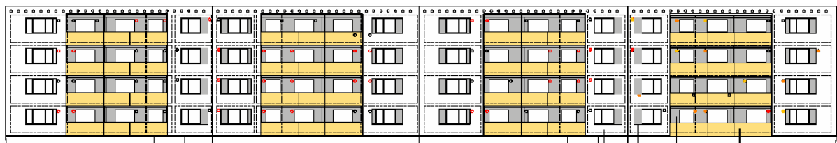
Abb. 21 Planung Sanierung Ansicht Süd mit Loggiaerweiterung
