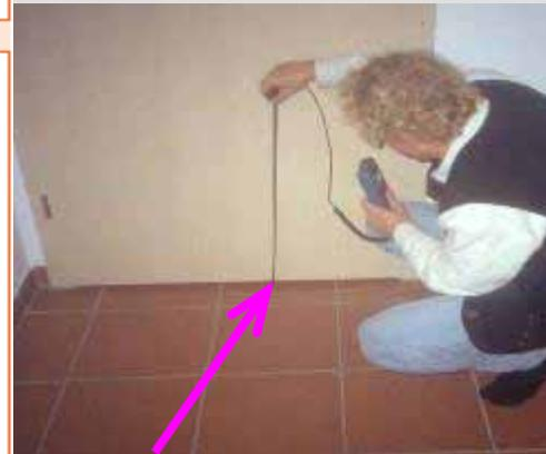
1 Luftgeschwindigkeitsmessung am Türspalt
