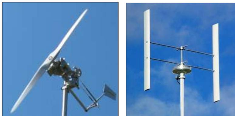
**Abbildung 46: Horizontal- und Vertikalläufer – Kleinwindkraftanlagen (BWE, 2009, o.S.)**
