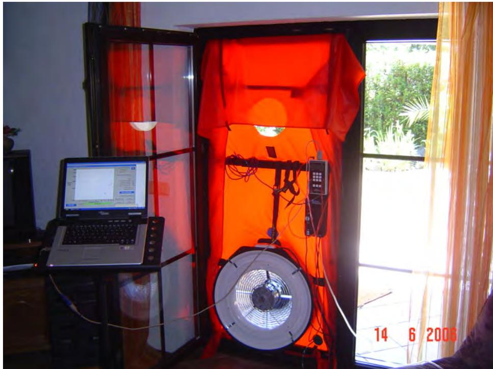
Abbildung 25 – Meßausrüstung Differenz-Druckmessung; Bildquelle: Bauthermografie & Luftdichtheitsprüfung Lutz Weidner / Thüringen
