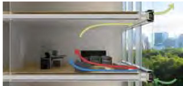
Abbildung 7 – Integrierte Lüftungstechnik in der Energiefassade; Quelle:
