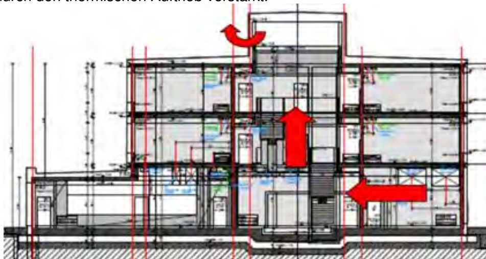
Abbildung 8: natürliche Nachtlüftung mit Hilfe von Klappen (Kah, et al. 2010)
