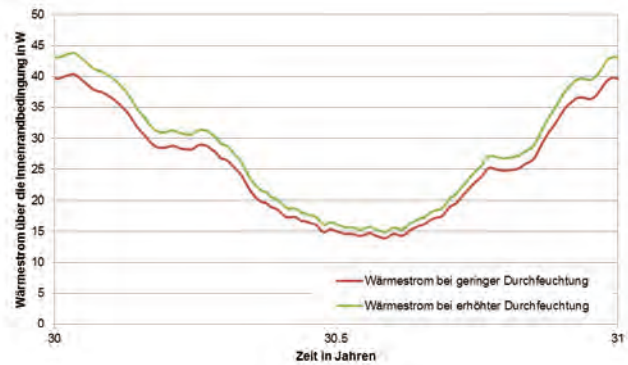
Abb. 100: Jahresverlauf des Wärmestroms über die Innenrandbedingung bei unterschiedlicher Lage der Dämmschicht
