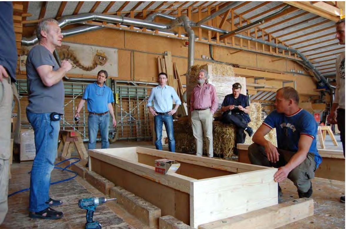
Vorgefertigte strohballededämmte Wand- und Decken-Module zur Demonstration einer passivhaustauglichen Montage auf der Virtuellen Baustelle und in der Zimmerei
