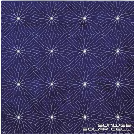
Abbildung 3: Rückseitenkontaktzelle Sunweb® der Firma Solland Solar. Die absorbierte Energie wird mittels Metal-Wrap-Through-Technologie (MWT) durch die Zelle hindurch zu den rückseitig angeordneten Leiterbahnen transportiert. Durch die Verlegung der Leiterbahnen steht auf der Vorderseite der Zelle mehr Fläche für die Absorption von Sonnenlicht zur Verfügung. (Quelle: Solland Solar)
