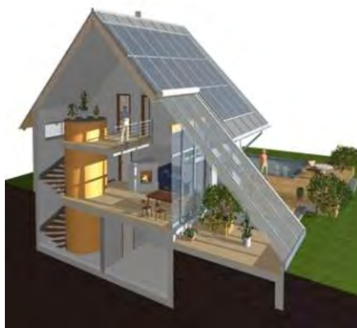
Abbildung 1: Modell eines Sonnenhauses mit südseitig ausgerichteter Solaranlage und Pufferspeicher im Gebäudeinneren
