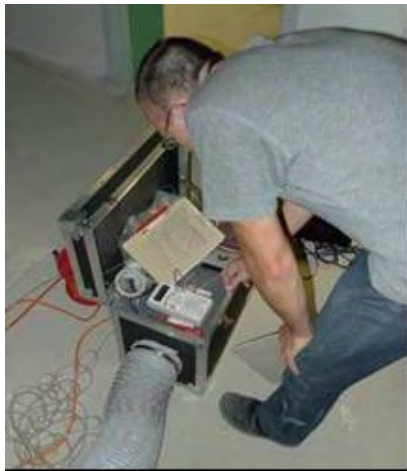
Abbildung 20: stichprobenartige Leckagemessung einzelner Luftleitungsabschnitten
