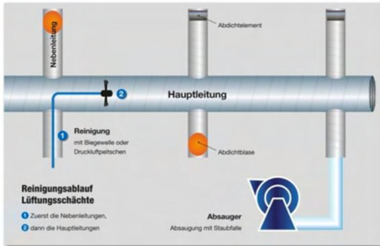
Abbildung 6: Prinzipschema einer Bürstenreinigung, Quelle: breg-rauchfangkehrer.at
