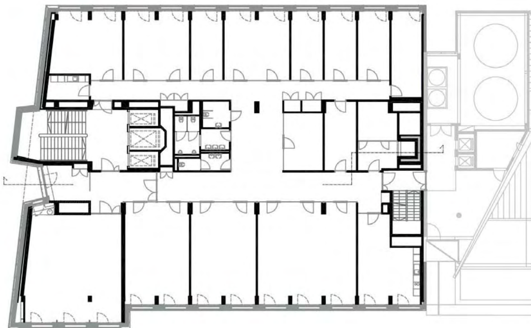
Abbildung 7: Plus-Energie-Bürogebäude - Regelgeschoß nach der Sanierung (Quelle: ARGE der Architekten Kratochwil-Waldbauer-Zeinitzer)
