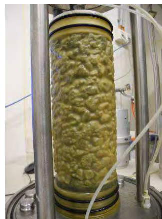
Abbildung 3-72: Probekörper für die Triaxialversuche (links), Probe mit übergestülpter Gummimembran (rechts)
