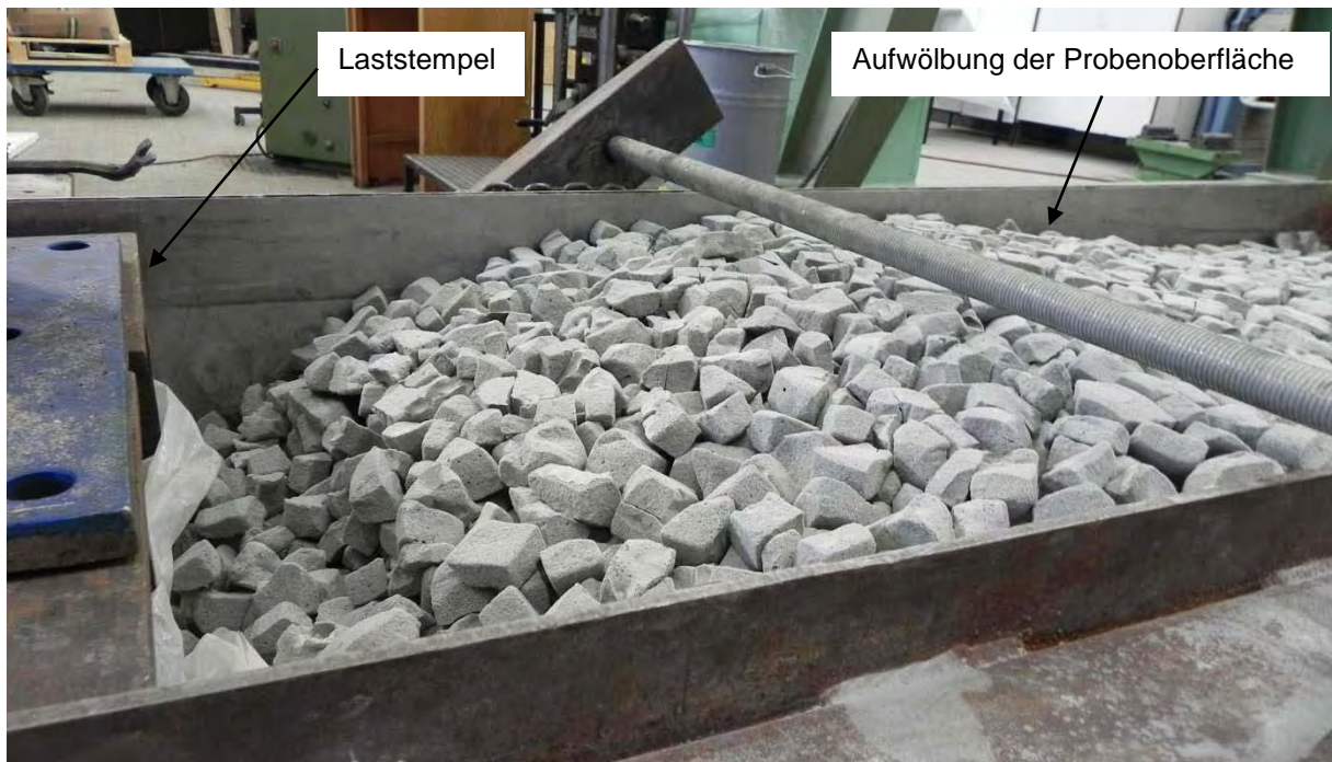
Abbildung 3-105: Aufwölbung der Oberfläche der Probe seitlich des Laststempels während des Versuchs
