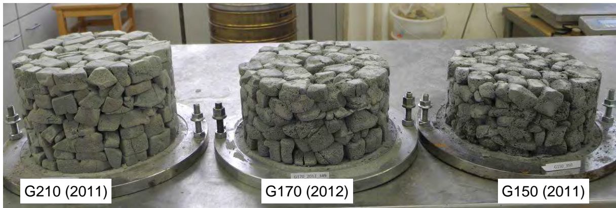
Abbildung 3-80: Proben nach der Beanspruchung – Verzahnung der Körner
