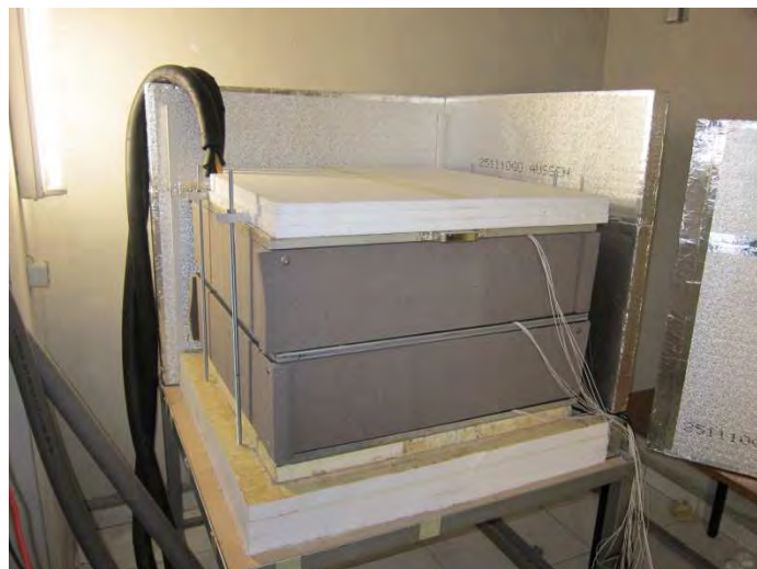
Abbildung 4-16: Modifizierte 2-Platten Apparatur zur Aufnahme von Schaumglas-Granulat-Schüttungen
