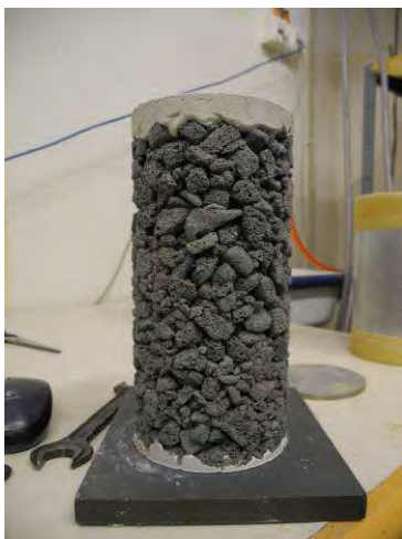
Abbildung 3-72: Probekörper für die Triaxialversuche (links), Probe mit übergestülpter Gummimembran (rechts)
