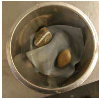
Abbildung 3-31: Prisma der zweiten Versuchsserie mit Sicherung gegen Aufschwimmen vor (Mitte) und nach 10 Frost- Tauwechsel (rechts)
