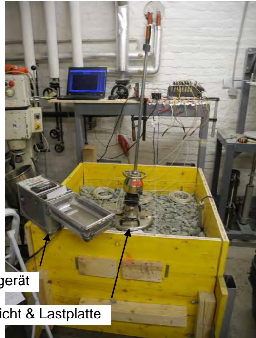
Abbildung 3-113: Versuchsbehälter, Anordnung der Erddruckdosen EH und EV, Lastplatte, Fallgewicht und elektronisches Messgerät
