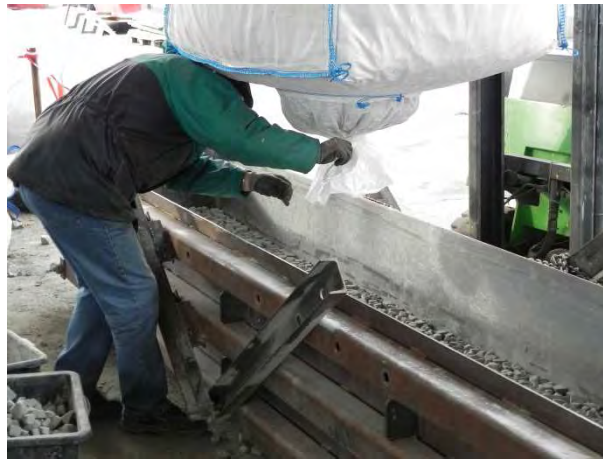
Abbildung 3-82: Einfüllen von Glasschaumgranulat in den Versuchsbehälter
