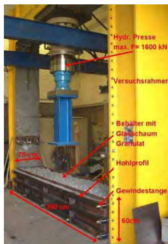
Abbildung 3-81: Großmaßstäbliche Versuchsanordnung Universität Innsbruck
