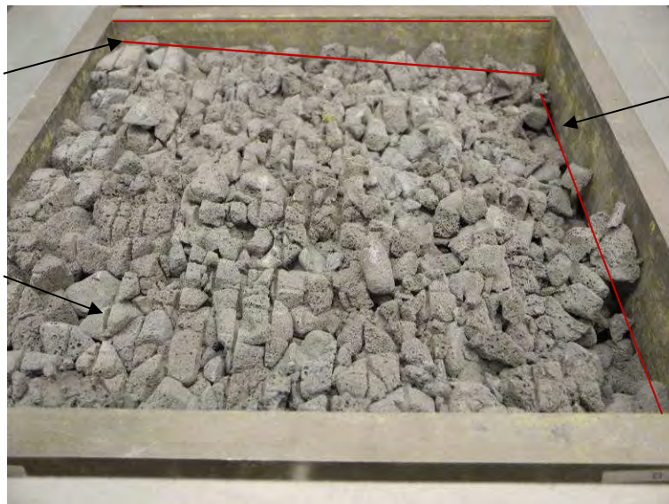
Abbildung 3-69: Darstellung des Kippens der Platten für die Lasteinleitung (oben); Oberfläche der Probe nach dem Scherversuch \sigma = 100 \text{ kN/m}^2 (unten)
