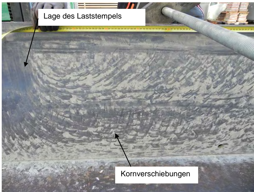
Abbildung 3-106: Darstellung der Kornverschiebungen durch Kornabrieb von der Probe an der Seitenwand des Versuchsbehälters
