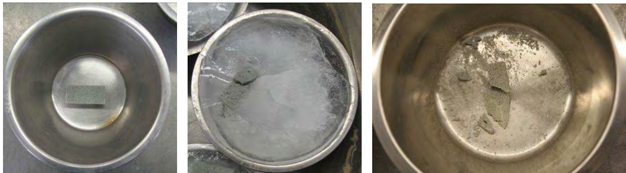
Abbildung 3-30: Ein Prisma der ersten Versuchsserie vor (links), während (Mitte) und nach einen Frost- Tauwechsel (rechts)
