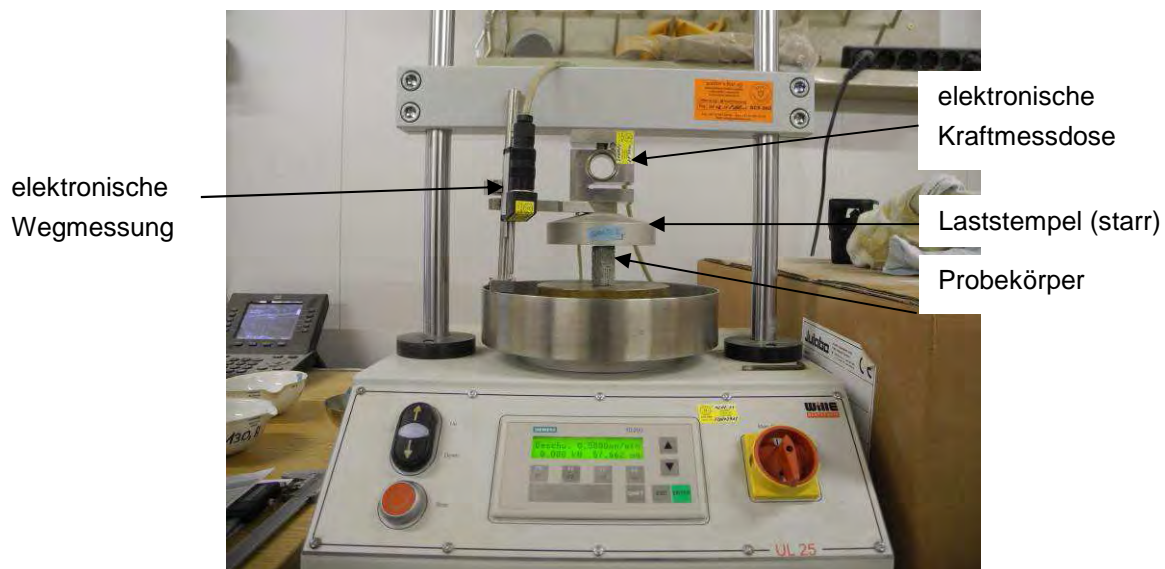
Abbildung 3-4: elektromechanische Presse zur Durchführung der einaxialen Druckversuche
