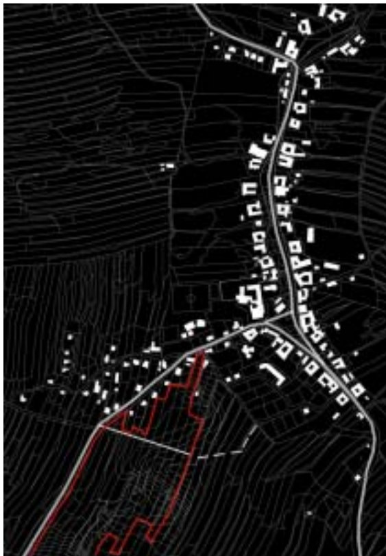
Abb. 128: Die wichtigsten Straßen mit der vorgeschlagenen neuen Erschließung für das Planungsgebiet mit einer möglichen Anbindung an das bestehende Siedlungsstraßennetz
