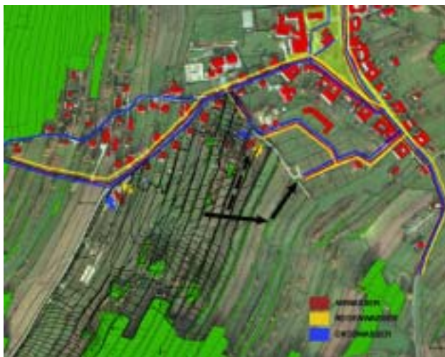
Abb. 115: Öffentliche Infrastruktur und die durch die Topografie vorgegebene Anbindungsmöglichkeiten für das Regenwasser und das Abwasser (schwarze Pfeile)
