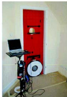
Bild 3: Aufbauten eines Blower DoorTests (arsenal research)
