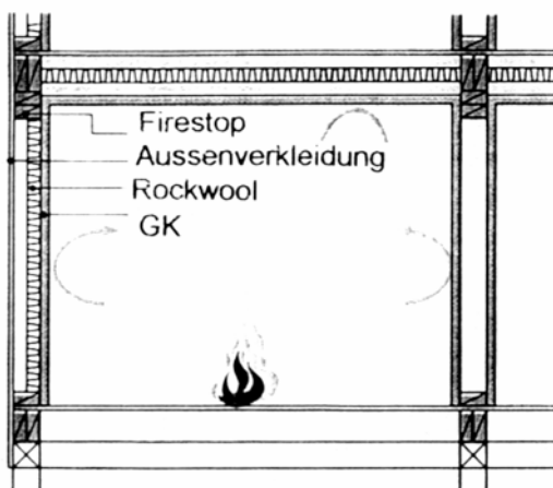
Abb. 107: Einsatz von Feuerstoppschwellen
