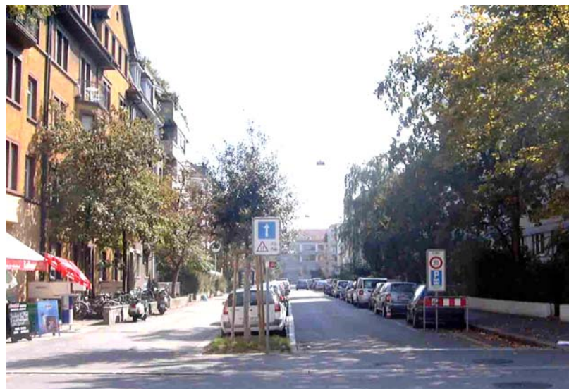
77. Ein breiter Gehsteig (links) hält den ruhenden Verkehr entfernt
