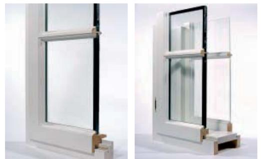
Abb. 3, 4: Energie Tirol: Nachbau eines historischen Fensters mit Zweischeiben-Wärmeschutzverglasung. Beim Kastenfenster wird die Wärmeschutzverglasung im Innenfügel ausgeführt. Fotos: Watzek
