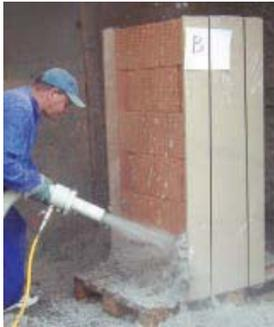
Abb. 6: Zellulosedämmschicht, Aufspritzversuche
