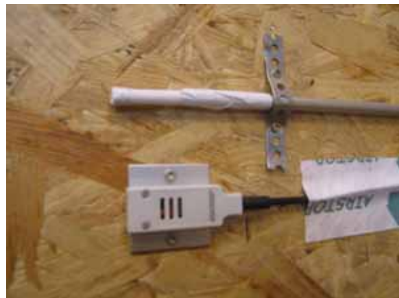
Abbildung 59 – Eingebauter Taupunkt-detektor und kombinierter Temperatur- und Feuchtesensor
