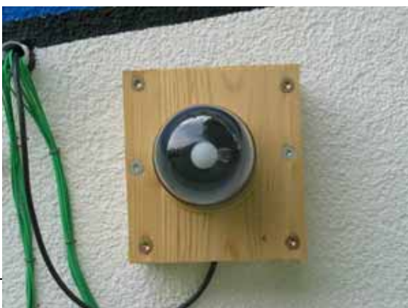
Abbildung 32 - Globalstrahlungssensor an der Fassade
