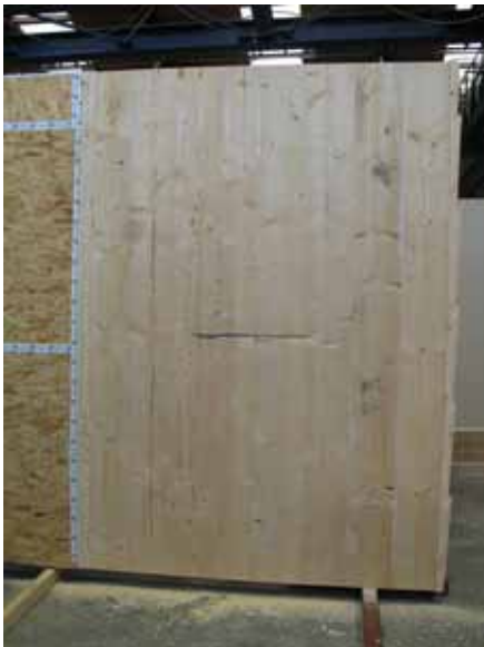
Abbildung 78 – Ansicht Massivholzelement mit gefrästem Schlitz für die Messtechnik
