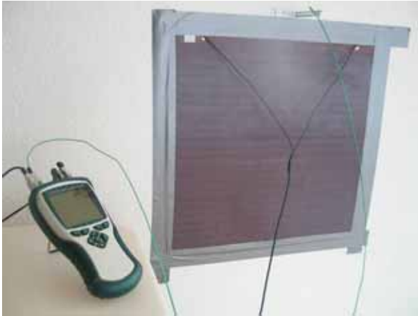
Abbildung 46 - Wärmeflussplatte inklusive Temperatursensoren und Datenlogger
