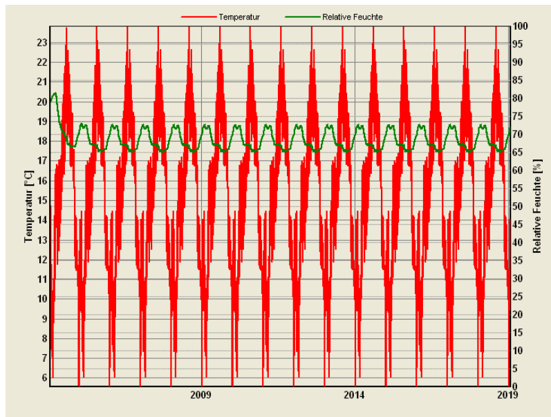
Abbildung 73 - Verlauf der relativen Feuchten und Temperaturen an der Grenzschicht EPS - OSB
