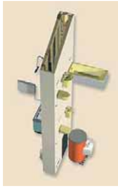
Abbildung 68: 3D-Ansicht Installationskern, Bau-Fritz GmbH.
