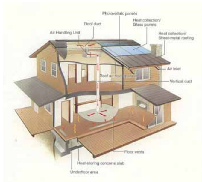
Abbildung 31: OM Solar – Schema des Luftheizungssystems.
