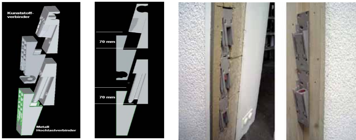
Abbildung 52: links: Konstruktion Hochlastverbinder mit Elektro- und Sanitärverbindung, rechts: erste Prototypenwand (Wasser, Strom, Datenbus) der Fa. Munitec.
