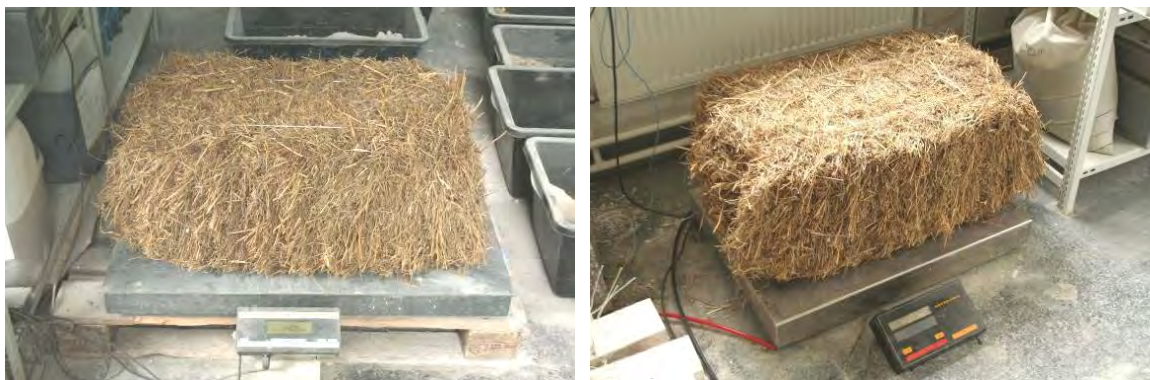
Abbildung 49: Gewichtsbestimmung von Kleinballen mit Bodenwaagen
