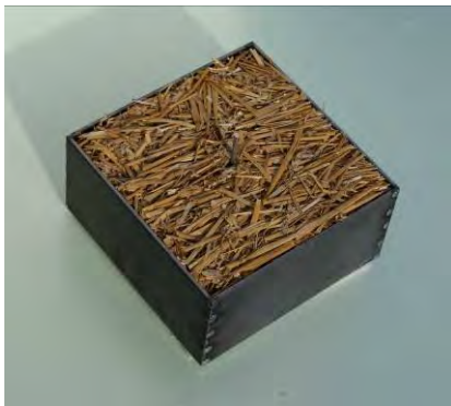
Abbildung 10: Probekörper für die Bestimmung der Dimensionsstabilität
