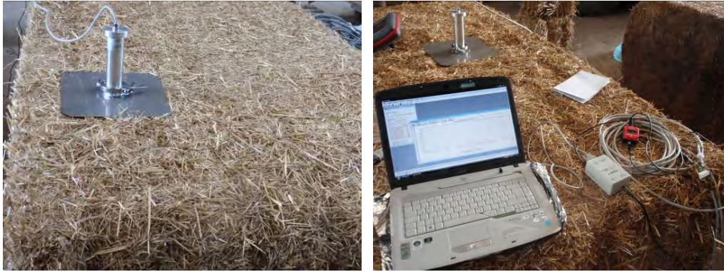
Abbildung 48: Testmessung mit dem Prozess-Mikrowellen-Feuchtemesskopf „Moist PP“
