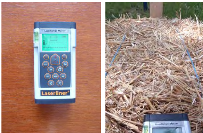
Abbildung 51: Links: Laser-Entfernungsmesser LaserRange Master LRM 60. Rechts: Vermessung eines Strohballens
