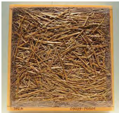
Abbildung 12: Probekörper für die Bestimmung der Wärmeleitfähigkeit
