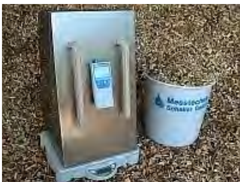
Abbildung 46: Biomasse-Feuchtemessgerät für Schüttmaterialien
