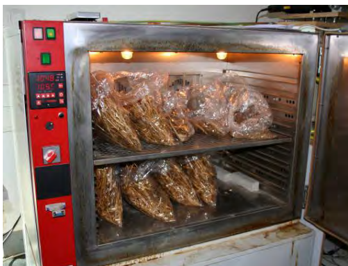
Abbildung 43: Sorptionsproben im Klimaschrank
