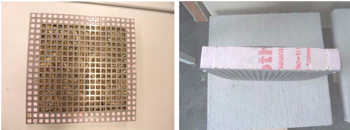
Abbildung 54: Strohprobe in Halterung für die Wärmeleitfähigkeitsmessung mit dem Heizkasten. Links: Ansicht von oben. Rechts: Ansicht von der Seite
