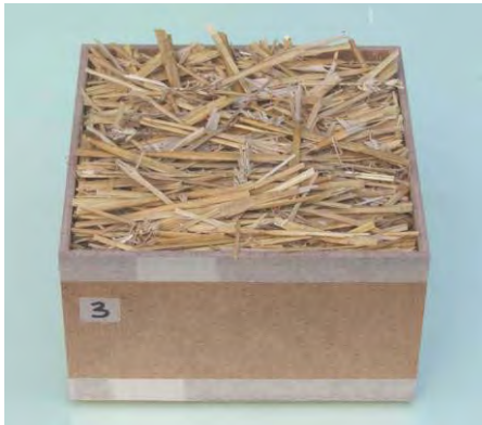
Abbildung 13: Probekörper für die Bestimmung des Strömungswiderstandes
