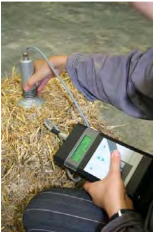
Abbildung 47: Mikrowellenfeuchtemessgerät „Moist 100“ mit Messkopf „Moist P“
