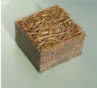
Abbildung 11: Probekörper für die Bestimmung der Wasseraufnahme
