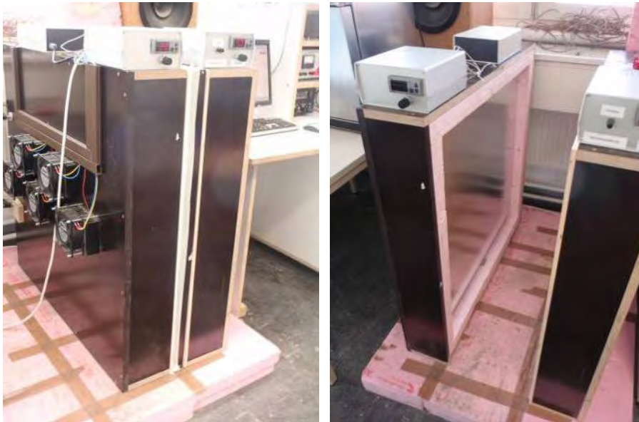
Abbildung 53: Links: Heizkasten im Betrieb mit eingespannter Probe und Abluftelementen auf der Kaltseite. Rechts: Luftleitblech auf der Kaltseite
