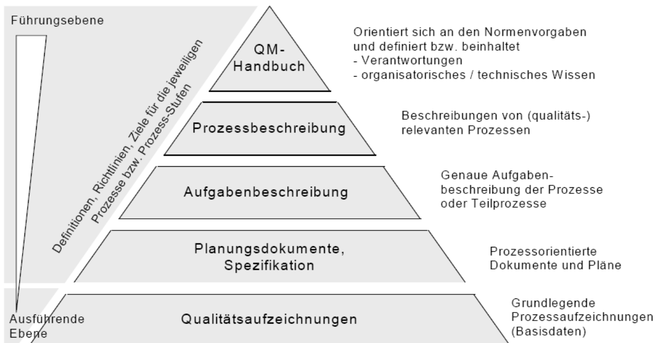
Abbildung 39: Beispiel für den Aufbau eines Qualitätsmanagement-Systems nach ISO 9001 7
