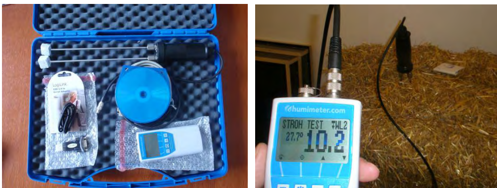
Abbildung 44: Links: Humimeter FLW-Messkoffer. Rechts: Humimeter FLW bei der Messung
