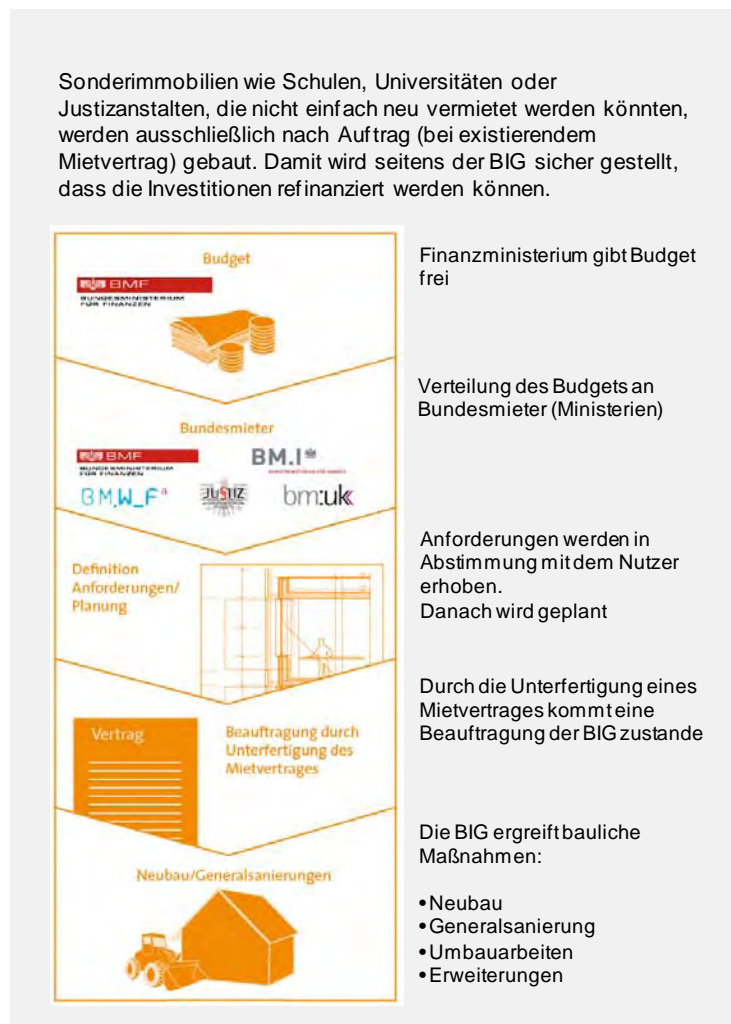
Abbildung 4: Standardprozess der BIG bei Generalsanierungen (Quelle: BIG)
