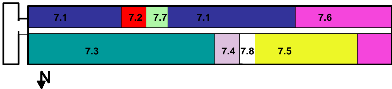
Abbildung 112: Thermische Zonierung des 7. Obergeschoßes in die sieben Zonen 7.1 bis 7.7.
