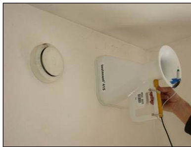
Abbildung 3.7: Messaufnahme mit Hilfe des Messtrichters
