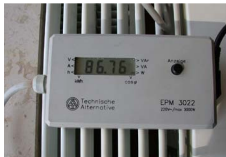
Abbildung 3.6: Strommessung mit Zwischenstecker
