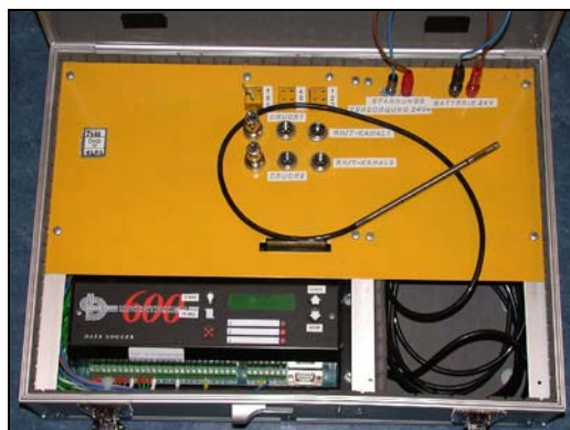
Abbildung 3.2: Messkoffer mit Anschlüssen der Messaufnehmer
