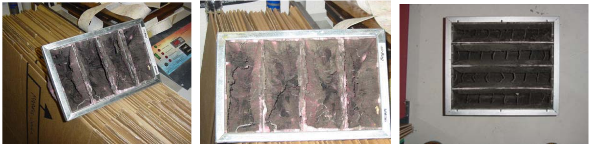
Abbildung 3.100 a-c: Verschmutzte Taschenfilter
