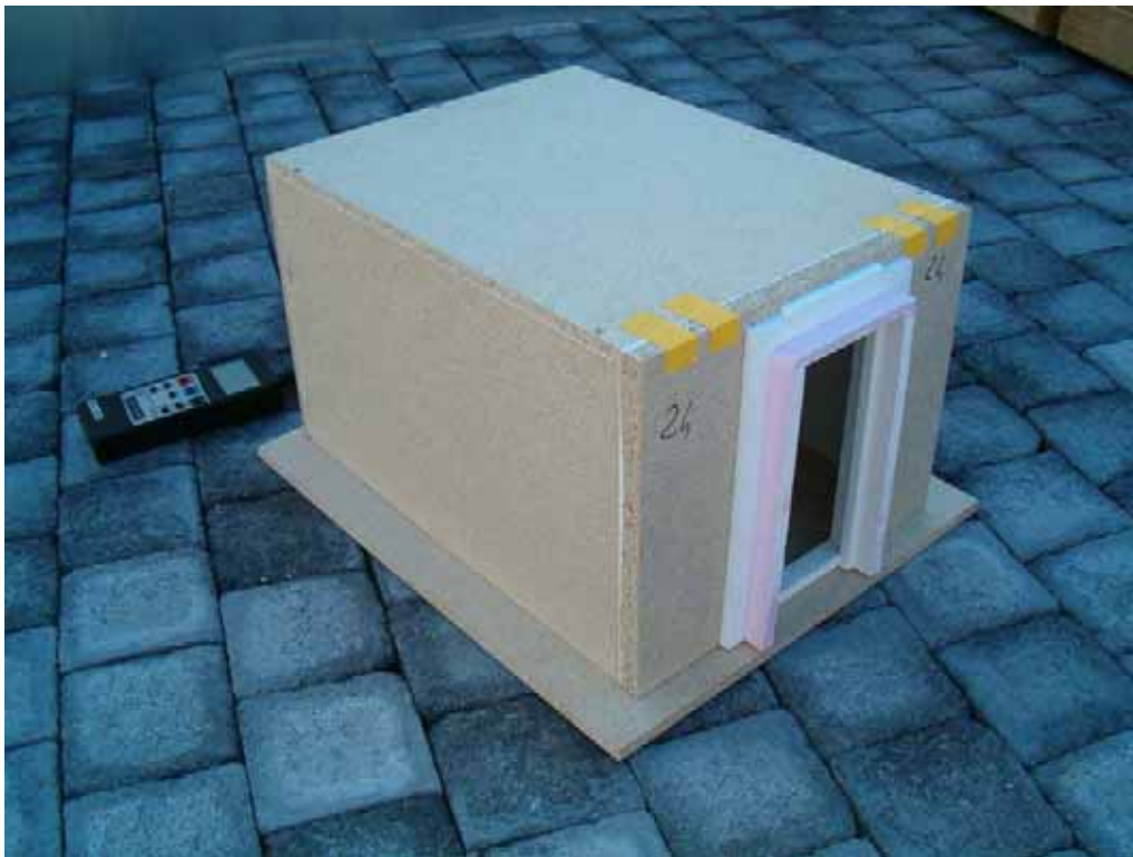
Abb. 61 das Raummodell für die Lichtmessungen
