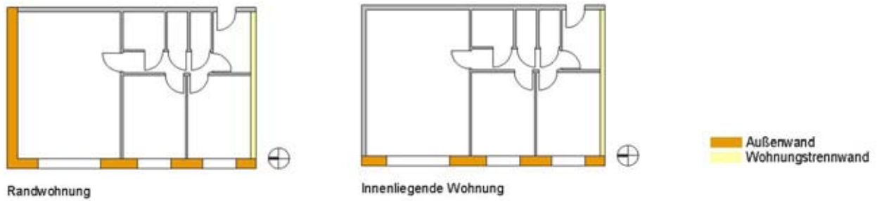
Abb. 32 Aussenmauern der Wohnungen
