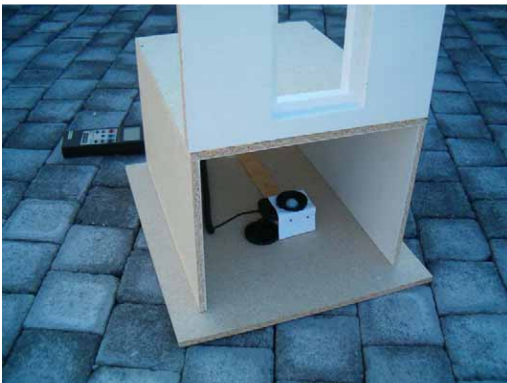
Abb. 62 Modell und Luxmeter
