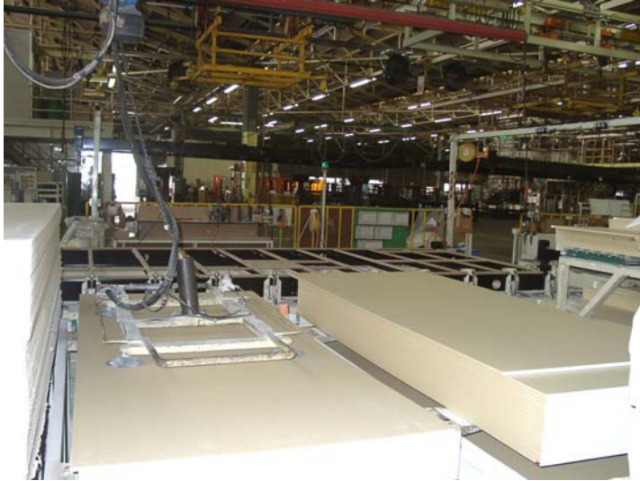
Abbildung 5: Werk Kasugai: Automatisierungsgrad bei der Produktion von Wandelementen
