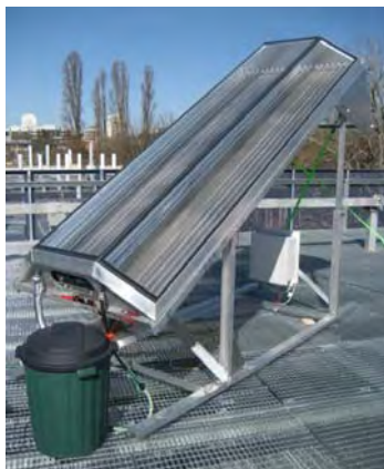
Prototyp des Hybridkollektors am CSES [Quelle: Resch, 2012]
