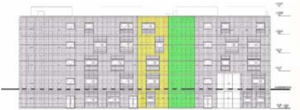
Abb. 18 Ansicht Südfassade mit Messfeld „Fenster“ (links) und Messfeld „Wand“ (rechts)
