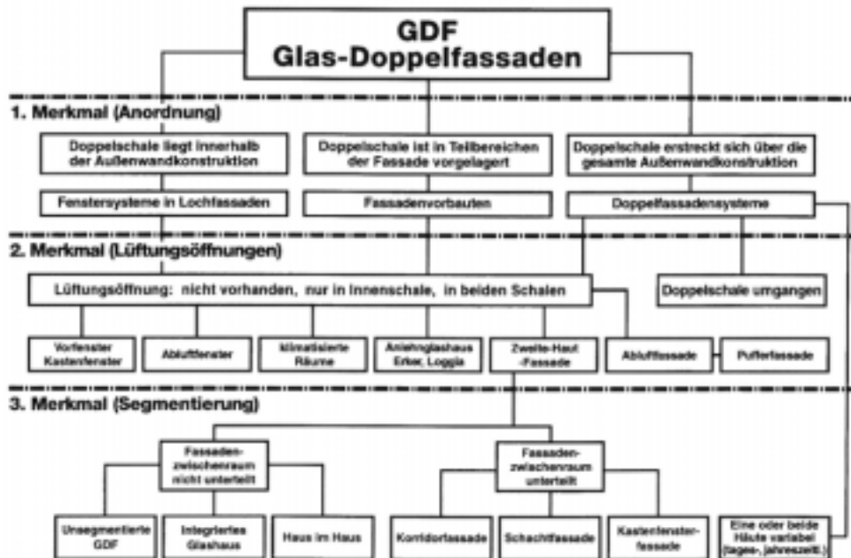
Abb. 6 Schematisiertes Ordnungsschema für GlasDoppelFassaden [Gertis, 1999]
