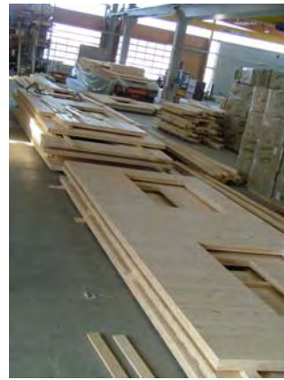
01.02.2006: KLH-Platten vorbereitet zur Fertigung
