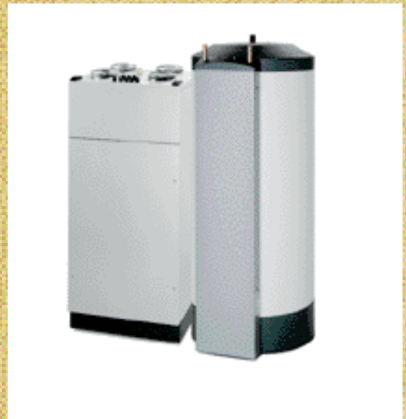
Kompaktní zařízení s tepelným čerpadlem a zásobníkem určené pro pasivní dům. Veškerá domovní technika pro vytápění, přípravu teplé vody a větrání je integrována do jediného kompaktního přístroje velikosti mrazničky. Na teplý zásobník v pravé části obrázku může být dále připojen solární systém
