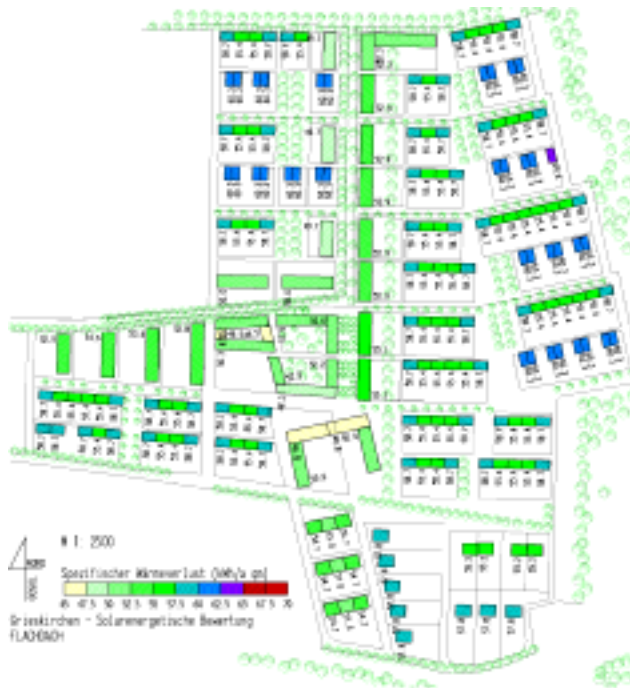
Abbildung 4: Spezifischer Wärmeverlust in kWh/m²a
