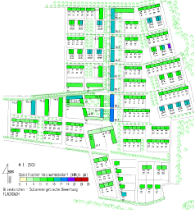
Abbildung 9: Spezifischer Heizwärmebedarf in kWh/m 2 a
