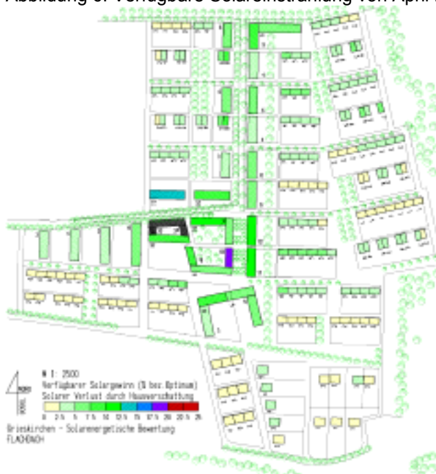
Abbildung 7: Solarer Verlust durch Hausverschattung
