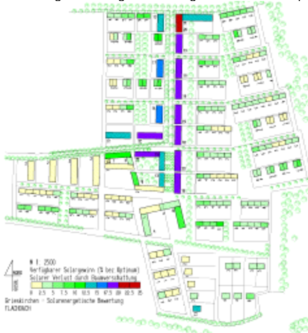
Abbildung 11: Solarer Verlust durch Baumverschattung (Flachdach)
