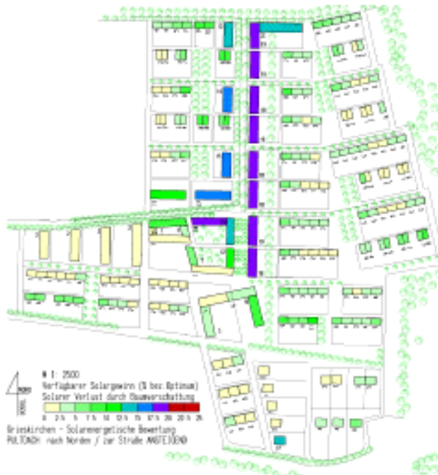
Abbildung 12: Solarer Verlust durch Baumverschattung (Pulldach)
