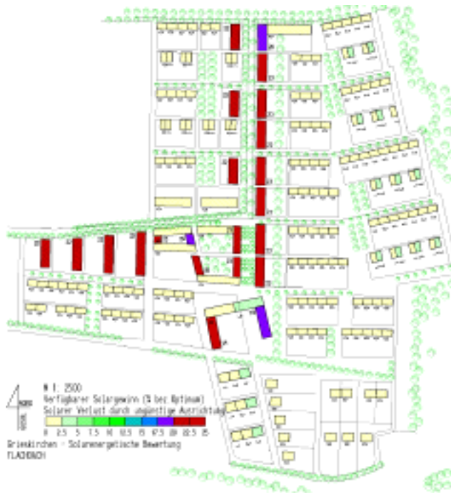
Abbildung 8: Solarer Verlust durch ungünstige Ausrichtung
