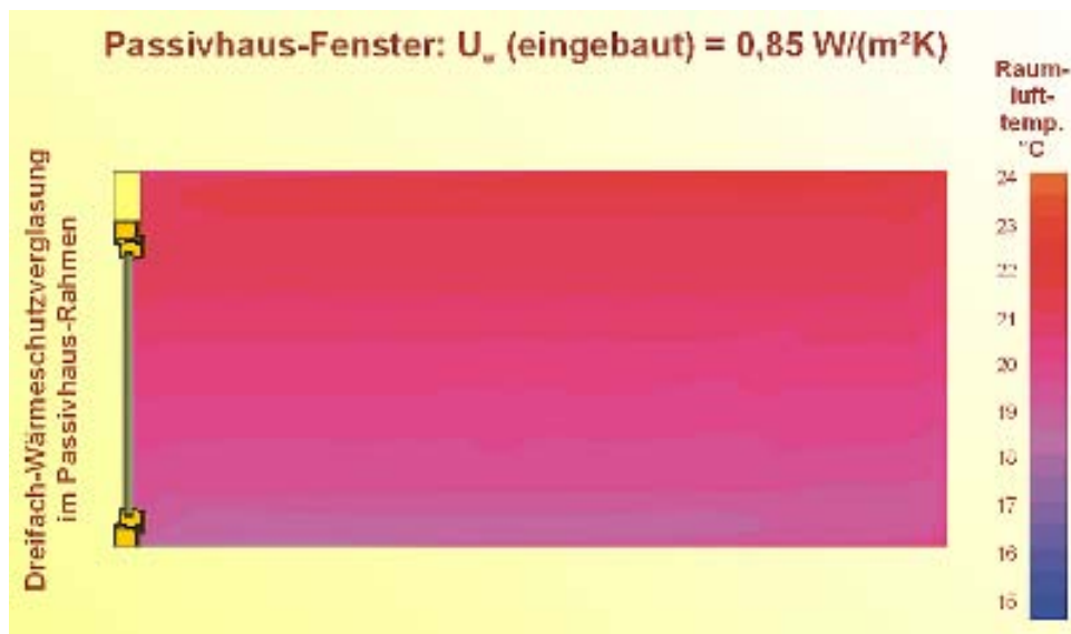
Abb. 2: Die Temperaturschichtung im Raum ist beim Passivhaus-Fenster nicht wahrnehmbar. Daher kann der Heizkörper auch an einer Innenwand stehen. [Quelle: www.passiv.de]
