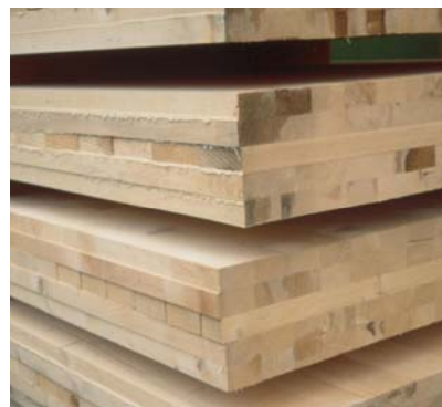
Abb. 4.4.4-1: Brettstapeldeckenelemente mit Nut- und Federverbindung untereinander bzw. mit einer Ausfällung quer zum Deckenelement zur Aufnahme einer umlaufenden Schwelle für die konstruktive Verbindung mit den Wandelementen
