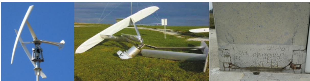
Abbildung 59: Schäden durch Vibrationen und Schwingungen (Quelle: Eigene Darstellung)
