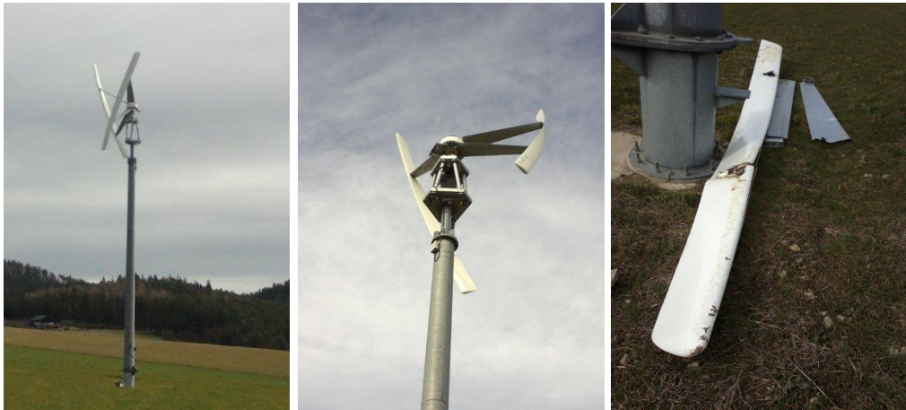
Abbildung 103 - Schaden Amperius VK250 (Quelle: Eigene Darstellung)
