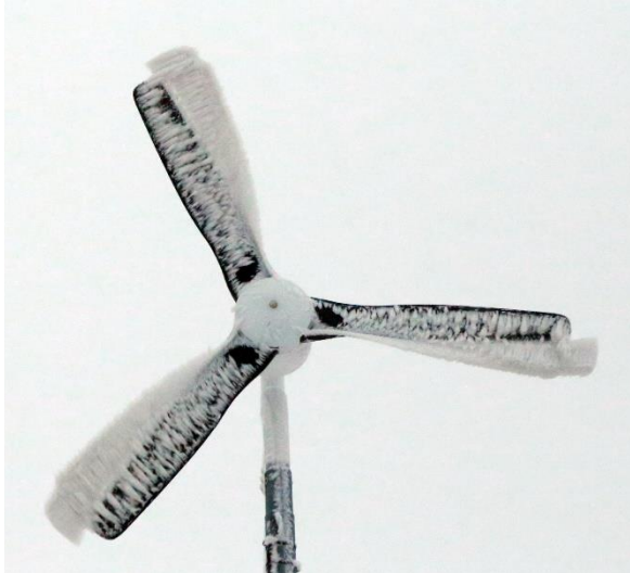
Abbildung 81: Vereiste KWEA Windspot 1,5 kW (Quelle: Eigene Datstellung)
