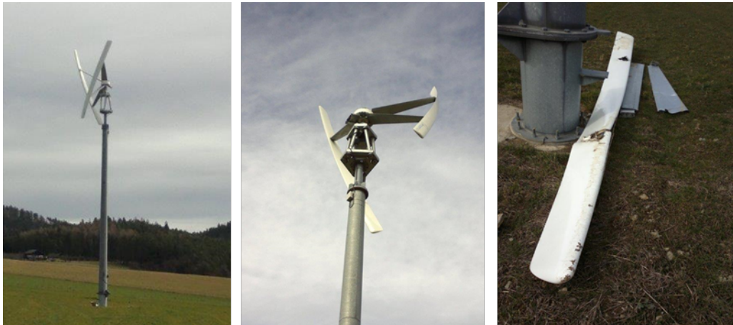
Abbildung 7: Totalschaden der KWEA Amperius VK250 Anfang März 2016 (Quelle: Eigene Darstellung)
